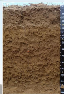
Exemple d'un brunisol sur loess observé à St-Just-Chaleyssin (Isère)
